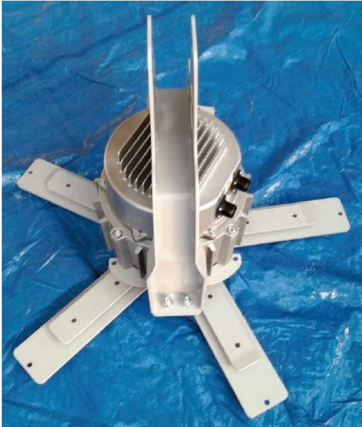
Después de colocar el motor invertir en el suelo, retire los tornillos de fijación del soporte.
