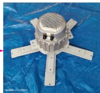
Para montar el soporte es necesario rotar el motor apoyándolo sobre la estrella. Coloque el soporte sobre el motor para centrar los orificios en la placa anticaída.
